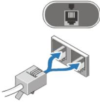
**Ilustración 8. Conexión de módem**
